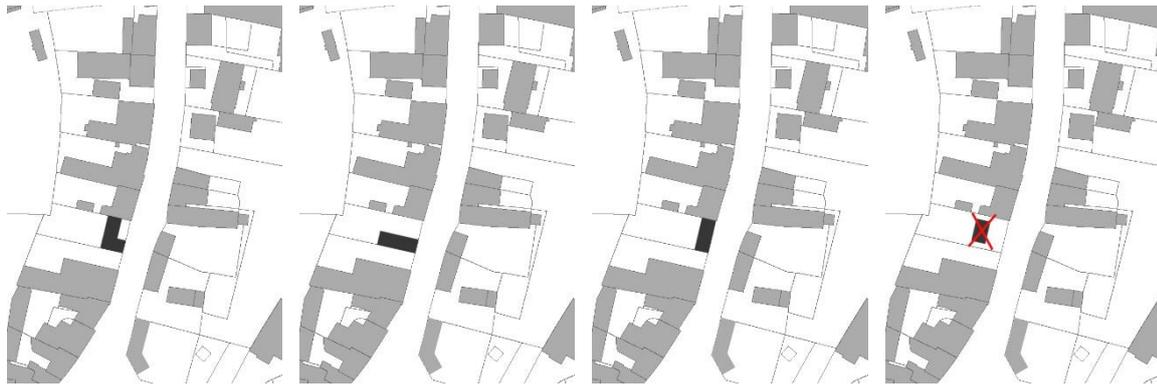
A l'angle de deux voies, l'implantation à l'alignement n'est imposée que sur l'une des voies.
