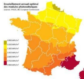
On remarque que le potentiel photovoltaïque de la région Bretagne est moyen. En effet, avec un ensoleillement annuel moyen d'environ 1500 à 1600h/an, le gisement permet d'envisager une production d'environ 1 200kWh/m<sup>2</sup> de module.
