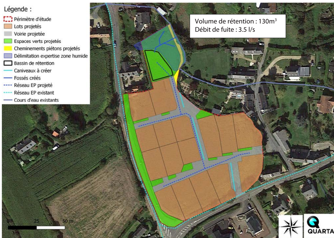
Illustration n°1. Gestion des eaux pluviales du projet. Schéma de principe
